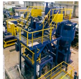
Zentrales Späneent-sorgungssystem für Stangenschälanlage mit Vakuum-Saug-schleuse und Silos für die Befüllung von Eisenbahnwaggons
