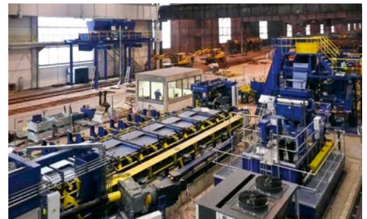
Zentrales Späneent-sorgungssystem für Stangenschälanlage mit Vakuum-Saug-schleuse und Silos für die Befüllung von Eisenbahnwaggons
